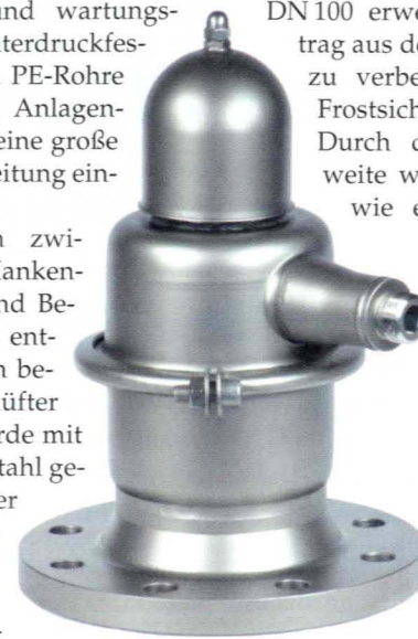
Der Ent- und Belüfter 1.59 mit integriertem Vakuumbelüftungsventil ist komplett aus tiefgezogenem Edelstahl hergestellt
